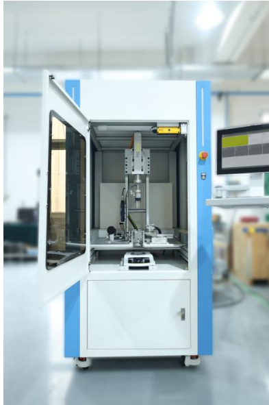
7-in-1-Teststation von Autoinjektoren mit integrierter Fügetechnologie von PROMESS
